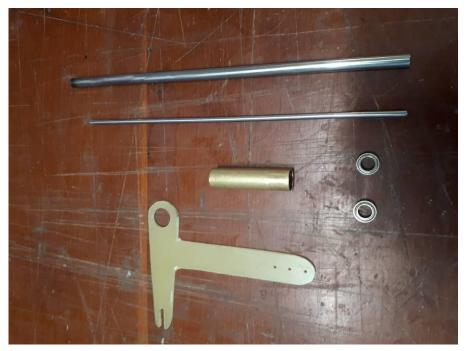
INSTALL THE BALL BEARINGS INSIDE THE BRASS TUBE AND THE STEEL BAR INSIDE THE BALL BEARINGS
