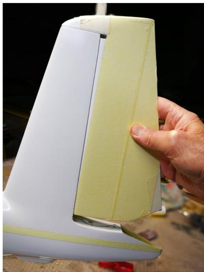
Passiamo ora alla fusoliera e precisamente al timone. Ricopro interamente con nastro di carta per protezione. Lo scopo è posizionare la linguetta di supporto asse rotazione più possibile sotto il bordo superiore del timone, quindi passo con la lima la parte alta del timone fino a ridurre più possibile lo spessore.
