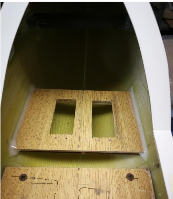
Incollo con resina bicomponente 5 minuti o più lenta. Quindi rinforzo con tessuto da 160 g/mq gli incollaggi della basetta e dei ponticelli (entrambi) che sostengono la basetta principale.
