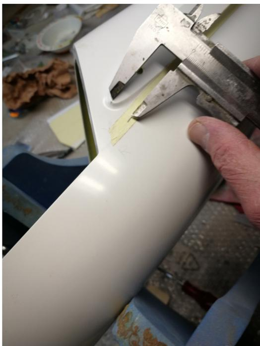
Passiamo ora alla parte anteriore della fusoliera, taglieremo il muso per adattarvi l'ogiva, che avrò scelto di diametro circa uguale al diametro del motore che intendo mettere. Devo avere un asse longitudinale di riferimento (che sarà molto vicino all'asse neutro del modello) per cui prendo una misura opportuna (15/20 mm) dal centro del karman anteriore e la riporto sulla fusoliera. La stessa misura la riporto dal centro karman posteriore
