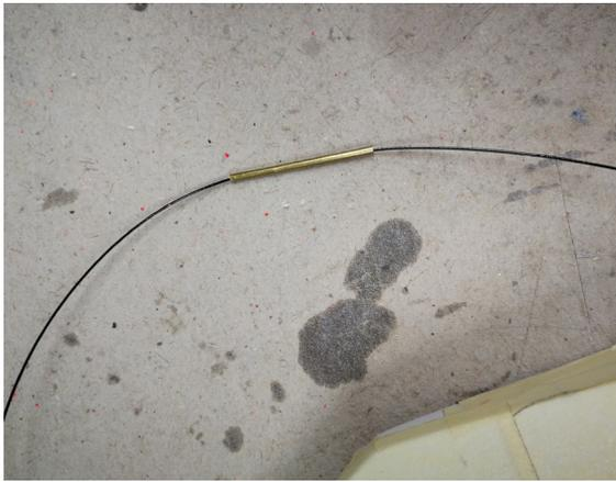
Prepariamo il comando pull pull del timone. Uso del filo di acciaio plastificato che si trova nei negozi di pesca di diametro 0,7 mm. Lo inserisco in un tubetto di ottone diametro 2 mm circa largo in maniera che sporga ai lati del timone come in figura e lo schiaccio al centro.
