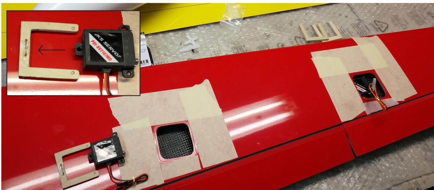
Usiamo i servi alari della classica misura standard 30x35x10 mm. Preparo una cornice di compensato di betulla da 4 mm con un accorgimento: un ponticello di filo di acciaio opportunamente dimensionato in modo che la lamella posteriore del servo entri con la dovuta pressione. Questo mi permetterà di fissare il servo solamente con le due viti anteriori.
