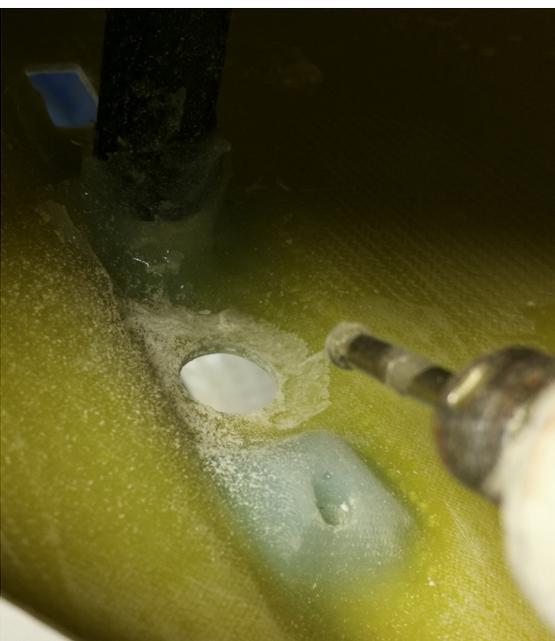
Preparo la sede interna alla fusoliera con la sfera diamantata per l'incollaggio. **IRRUIDISCO CON CARTA VETRATA IL CILINDRETTO** e lo inserisco per l'incollaggio con bicomponente molto addensata in maniera che copra il cilindretto fino al bordo superiore.
