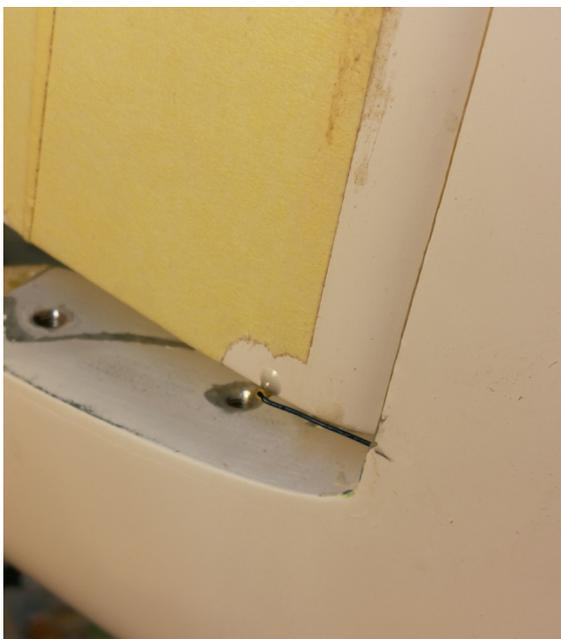
Rifinisco le estremità del filo con acciaio armonico da 1,5 mm che passerà nel nottolino di fissaggio. La squadretta sarà della stessa larghezza del timone. Questo sistema è molto pratico per la regolazione ma può essere sostituito con le tradizionali forcelle M2.
