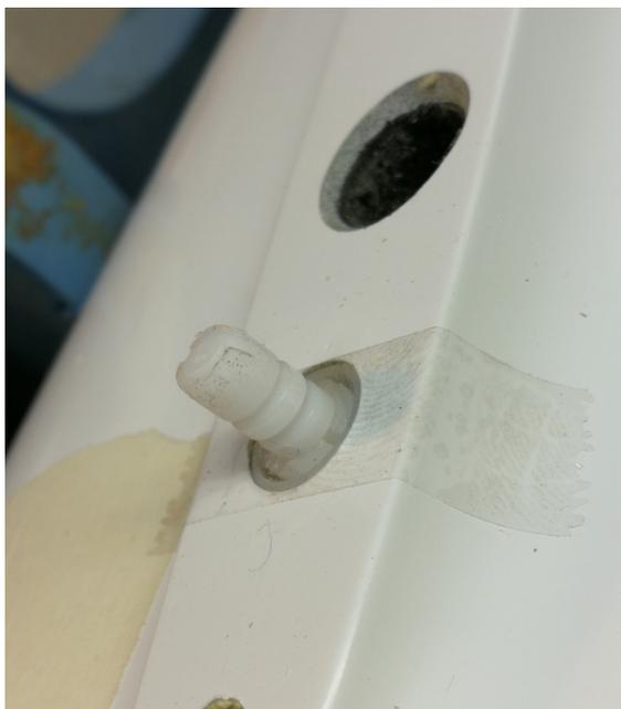
Quindi prepariamo l'incollaggio del nottolino sulla semiala. Dopo averlo irruvidito e scanalato per favorire la presa della resina, lo inserisco nel cilindro fino allo scatto di bloccaggio. Proteggere sempre le zone di lavoro con nastro adesivo. Riporto come in foto la posizione sull'ala e foro da 6,5
