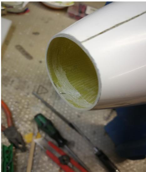
Con la mola diamantata a testina tonda preparo la sede dell'ordinata parafiamma. Preparo la stessa usando il materiale che preferisco. Io uso compensato di betulla spessore 4 o 5 mm. La faccio di diametro 5 mm maggiore del diametro motore in modo che si posizioni circa 5 mm più all'interno del bordo anteriore.
