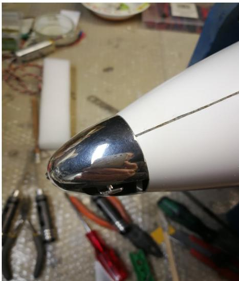
Quindi spingo dall'interno il motore finché ottengo il perfetto appoggio dell'ogiva, inserita sull'albero motore, alla fusoliera (foto a sx). A questo punto tolgo l'ogiva e, senza muovere nulla, incollo con bicomponente 5 minuti.
