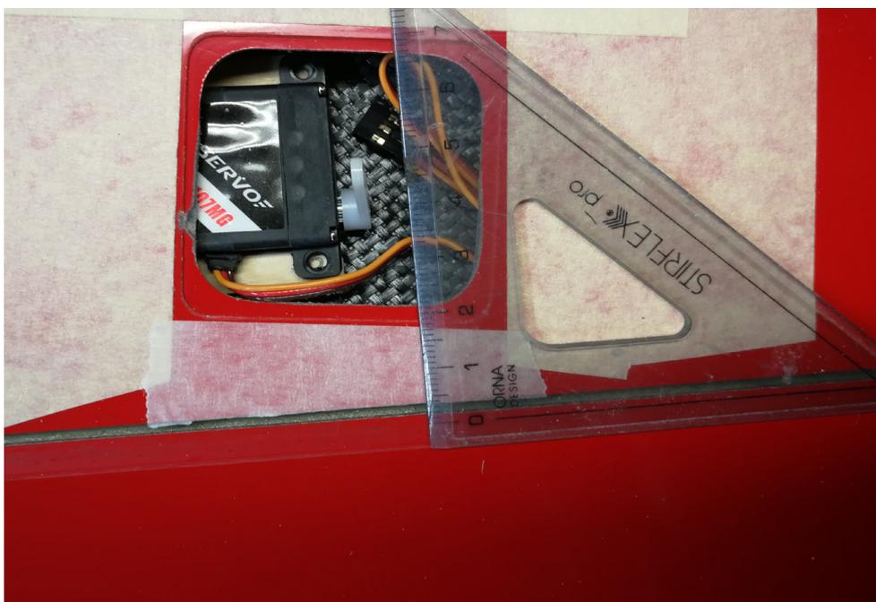
Questo sistema mi permette di posizionare il servo nella posizione che più mi aggrada, non essendoci più la necessità di accedere alla terza vite di fissaggio. Io posiziono il servo in modo che sia perpendicolare alla cerniera alare, che sarebbe la soluzione geometrica esatta (foto), ma si può anche centrarlo parallelamente ai lati della finestrella e con la squadretta più o meno vicina al lato.
