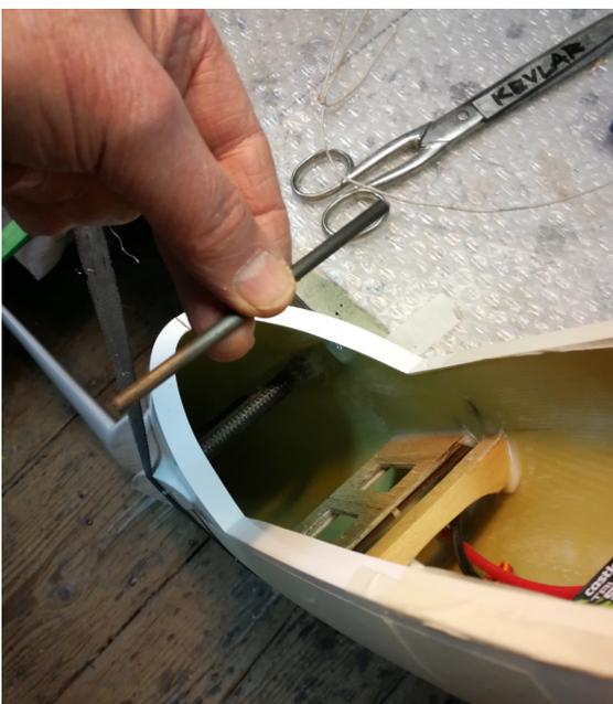
Preparo un tondino di tubo di carbonio da 5/6 mm e lo incollo all'interno della fusoliera sull'estremità posteriore del karman interno. Questo serve ad aumentare la resistenza allo schiacciamento della fusoliera. Se preferisco posso fare la stessa cosa anche per la parte anteriore del karman una volta terminato tutto il montaggio.
