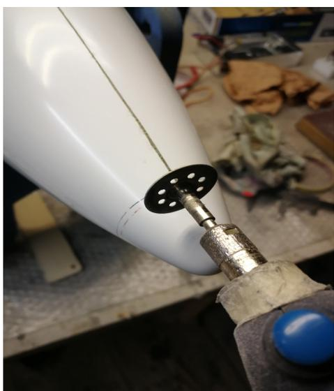
Tampono accuratamente fino ad avvicinarmi al primo segno di riferimento, quello che dovrebbe darmi un diametro pari a quello del motore e ogiva.
