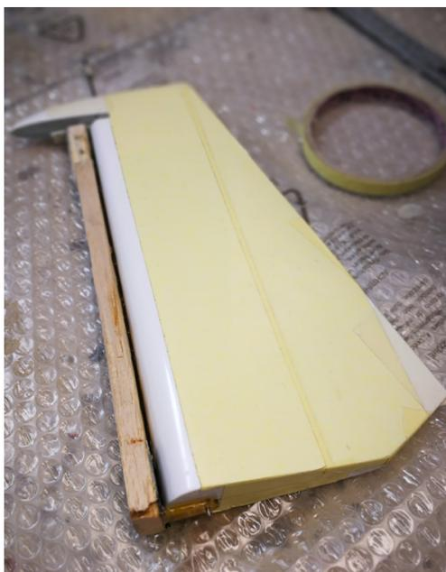
Curo la lunghezza delle linguette in modo che il timone abbia un paio di mm di luce e ruoti liberamente e senza attrito. Inserisco il tutto nella sua posizione e controllo che il piano di quota abbia il giusto spazio per poter essere inserito e fissato con le relative viti.
