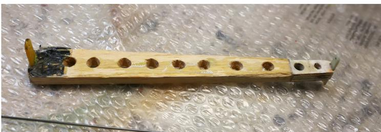
Preparo l'ordinata usando del balsa da 10/12 mm opportunamente forato e con le linguette di cerniera saldamente fissate alle estremità. Faccio una serie di fori per alleggerimento. Ho usato un balsa leggero (e un po' rovinato) ma dopo è prevista la fibratura di rinforzo.
