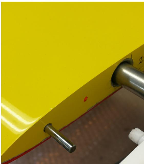
mm per una profondità, laddove possibile, di poco superiore alla lunghezza del nottolino. Spalmo la bicomponente addensata ed inserisco il nottolino nel foro fino a che l'ala si chiude bene contro il karman. Ricordarsi di provare questa operazione a secco, PRIMA dell'incollaggio!
