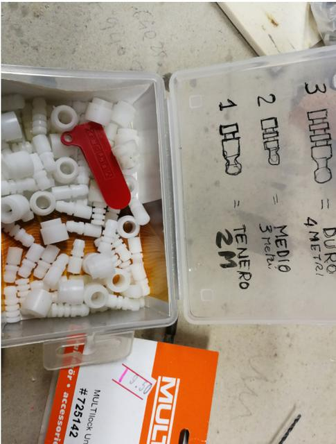
Vediamo ora il montaggio del sistema Multilock MPX di bloccaggio semiala. Uso il giunto di durezza media per ali da tre metri che ha due scanalature.
