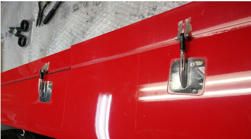
Ecco la prima semiala terminata. I copriservo li ho fatti con il pvc termoformato ma si possono usare quelli forniti col modello.
