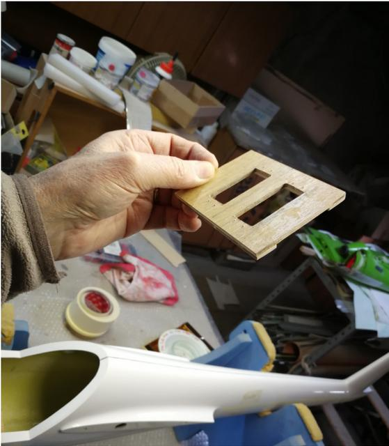
Preparo una basetta più piccola per i due servi del direzionale ed elevatore avendo cura di aumentare lo spessore sotto le viti di fissaggio.
