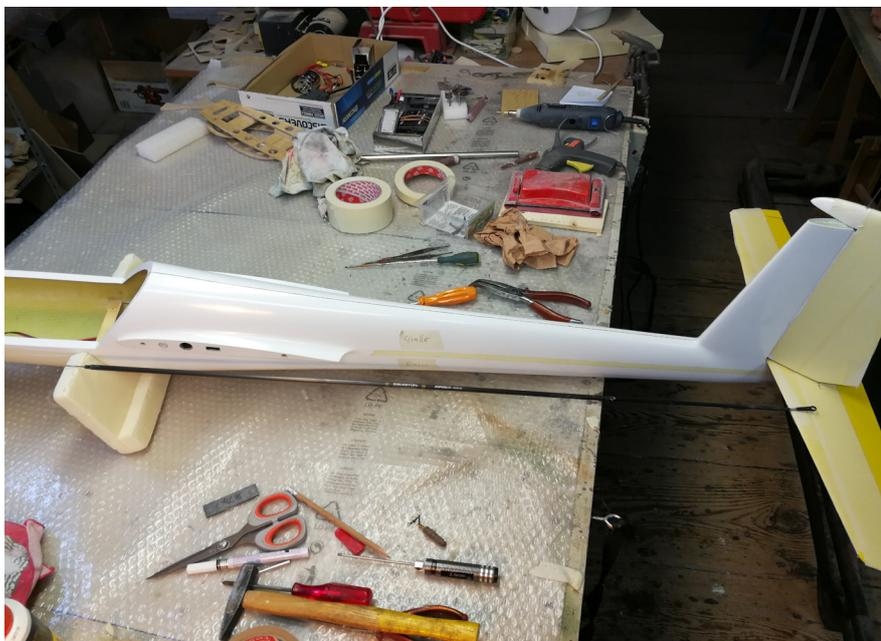
Per il comando dell'elevatore preparo un'asta in tubo di carbonio (io uso delle frecce da tiro con l'arco in carbonio e alluminio) del diametro di 6 mm circa. Calcolo la lunghezza opportuna che mi consente di portare il giunto uniball sotto la parte mobile dell'elevatore.
